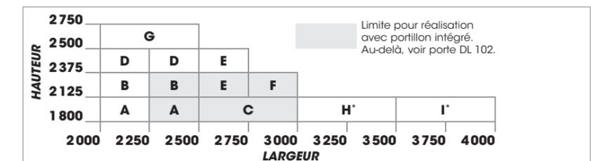
\* Dimensions adaptées pour un emplacement PMR, préconisées pour un usage en sous-sol. Notre conseil : ajouter l'option kit de manœuvre PMR. Bandeau central en cas de L > 3000 mm.
